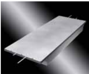
Pyrex-Nitride AFM probe 探针长方形悬臂的三维素描
