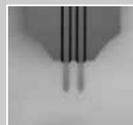
Arrow™ TL2 在单晶硅支架上带一排无针尖悬臂，两个悬臂梁
