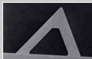
Pyrex-Nitride AFM Probe Triangular Tipless 长悬臂放大 图像
